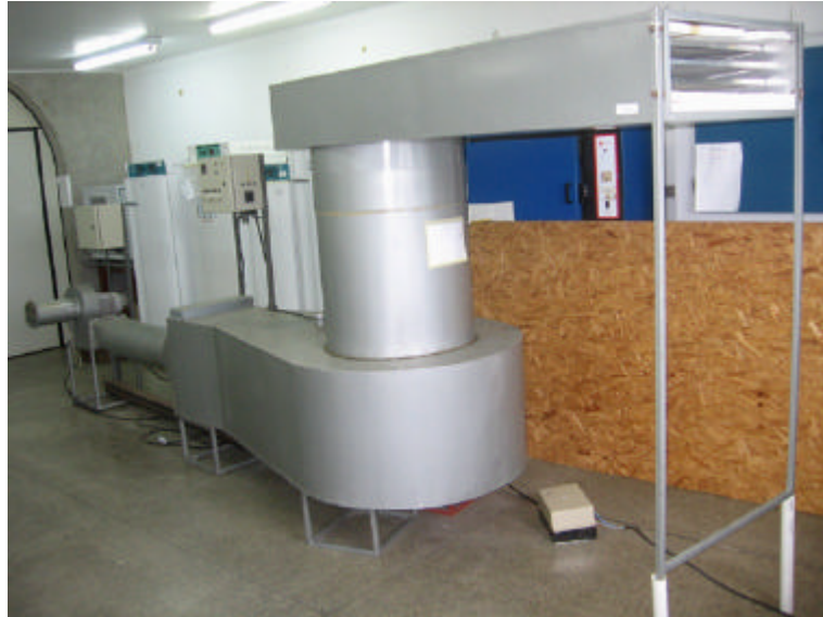
Figura 4. Secador protótipo de camada delgada utilizado na secagem das sementes de carambola.
