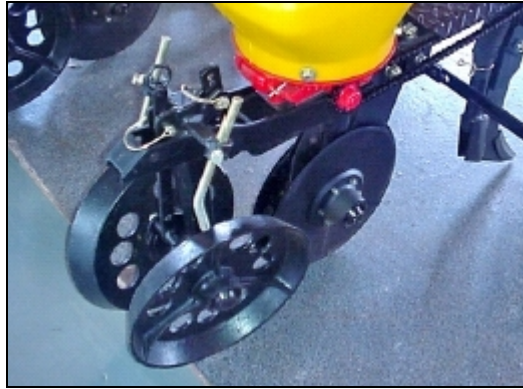
Figura 4 – Mecanismo sulcador do tipo disco duplo.
