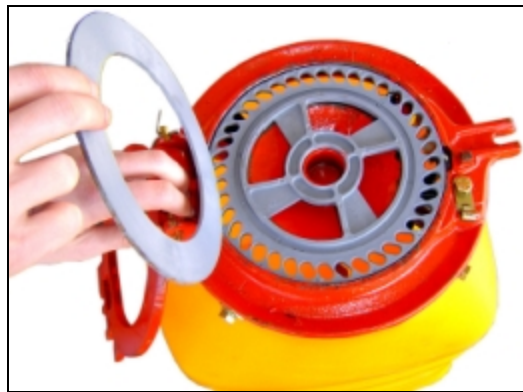
Figura 1 – Mecanismo dosador de sementes de discos perfurados horizontais.
