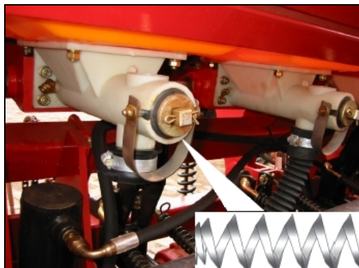
Figura 2 – Mecanismo dosador de adubo do tipo helicoidal.
