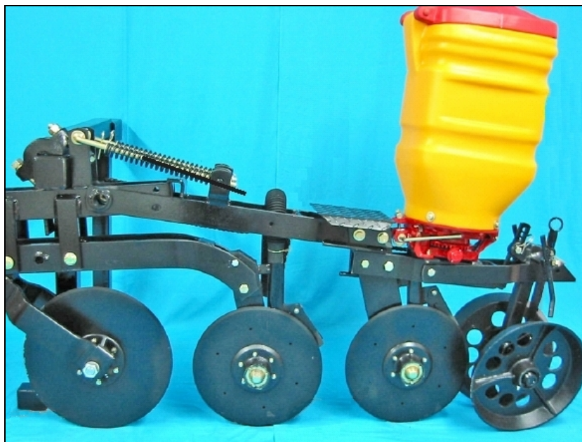
Figura 9 – Sulcadores do tipo discos duplos defasados para adubo e sementes.
