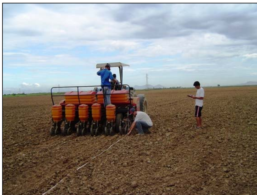
Figura 10 – Determinação da patinagem das rodas motrizes da semadora-adubadora.
