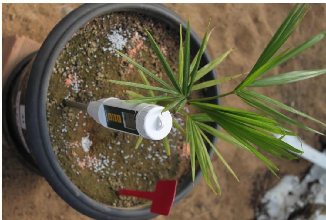
Figura 2A: Medidor de umidade de solo modelo MO750 da Extech® Instruments com haste de 20 cm de comprimento (expresso em %), mensuração a 15 cm de profundidade no substrato.
