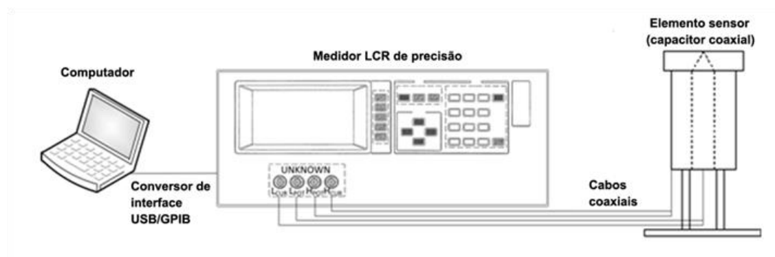
Figura 2. Diagrama esquemático do sistema de medição das propriedades dielétricas com coleta automática de dados.
