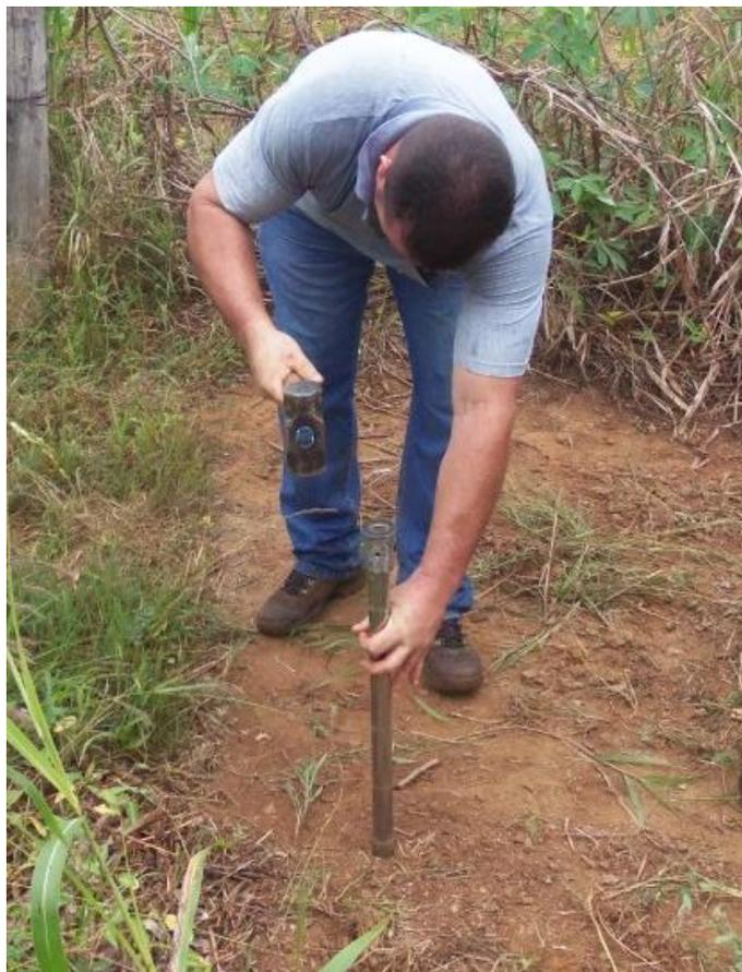
**Figura 5.** Coleta das amostras de solo. Ao centro o uso da sonda, e a área de gramínea ao redor.
