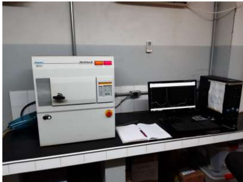
Figura 10. Equipamento de DRX Rigaku Miniflex II utilizado nas leituras das amostras de solo.
