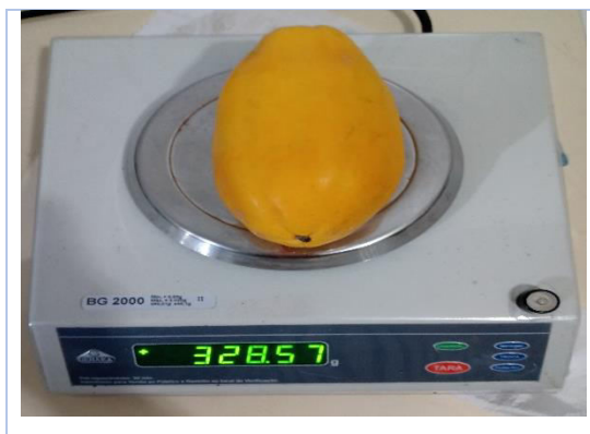
Figura 20: Pesagem dos frutos para análise de perda de massa. Fonte: acervo pessoal.
