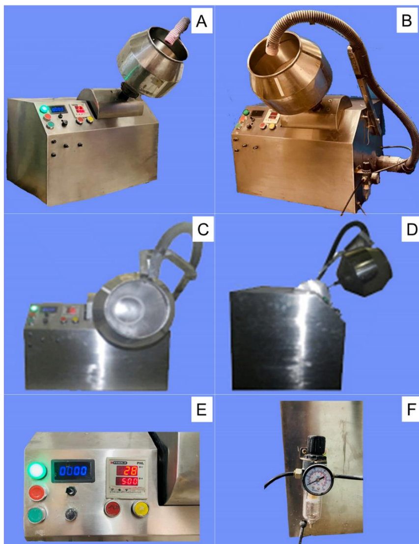
Figura 7. Protótipo para recobrimento de sementes após a montagem. (A-B) Visão total do equipamento; (C) frontal; (D) lateral direita; (E) painel de controle e (F) regulador de pressão.
