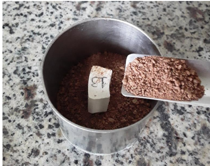
Figura 2. Blocos cerâmicos inseridos nos anéis volumétricos.
