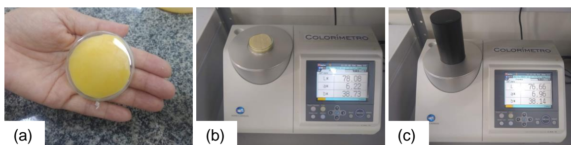
Figura 1. Amostra de queijo na cubeta de leitura (a); Cubeta com a amostra na superfície de leitura do Colorímetro (b); Leitura dos componentes de cor ( L^*a^*b^* ) (c).
