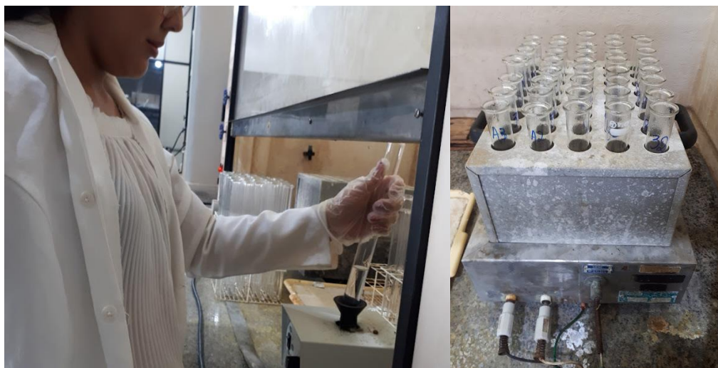
Figura 10A: Digestão do material vegetal em capela para as análises de Silício, Nitrogênio e Polifenóis totais, setor de nutrição mineral de plantas, LFIT – UENF. Campos dos Goytacazes, 2020.
