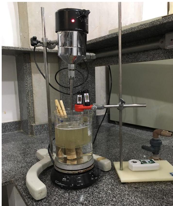
Figura 8 - Montagem da estrutura de elaboração dos géis, contendo o agitador mecânico, a manta de aquecimento, o Becker contendo solução de etileno glicol e rochas de cortiça que sustentam o Becker de elaboração do produto.
