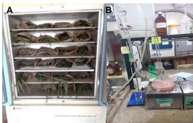
Figura 1: Estufa para secagem de material vegetal (A), aparelho tipo Clevenger modificado (B).
