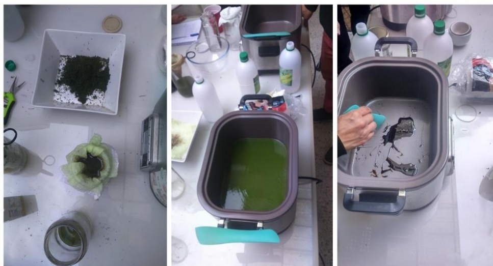
Figura 13 A primeira imagem mostra o processo de coagem e, ao lado, as panelas elétricas: a primeira bem no início da evaporação e a segunda com a resina quase pronta: um líquido escuro e espesso.
